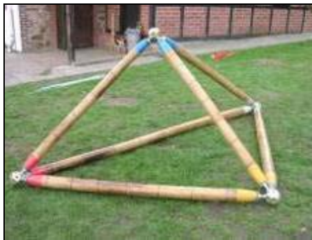
Foto 21, 22: Fijación axial de pernos en uniones cónicas de bambú y bola MERO.
